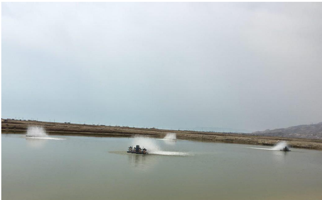
شکل ۱۰: هوادهای پارویی و چیدمان آن در استخرهای پرورش میگو
