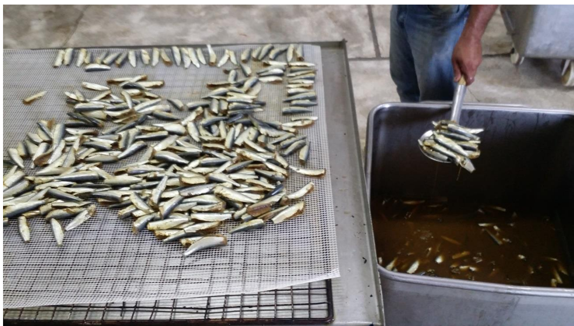
تصویر ۶-۲۸- چیدن ساردین ماهیان در سینی دستگاه خشک کن پس از سس گذاری.
