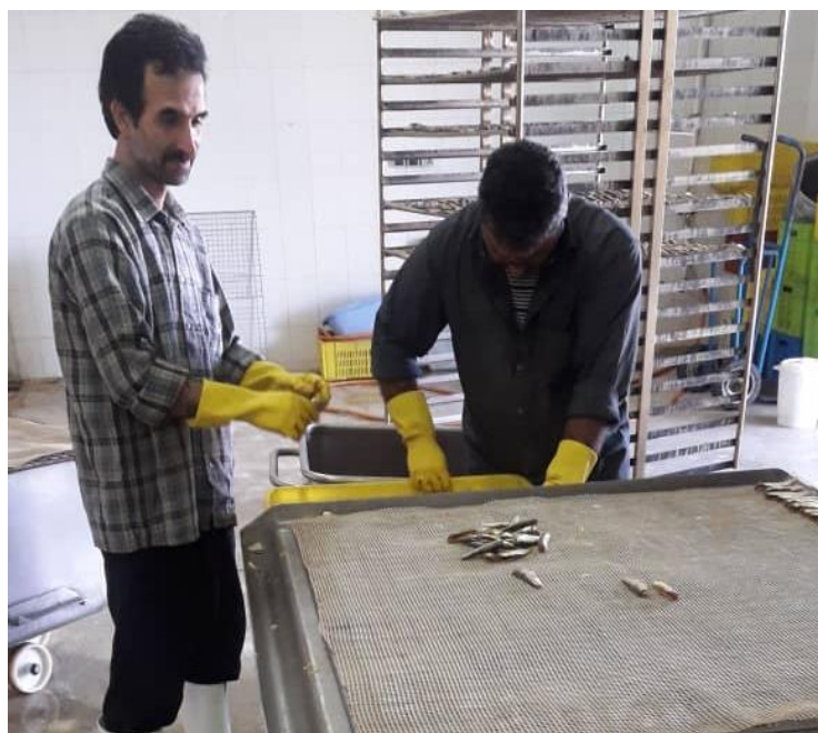
تصویر ۶-۱۶- چیدن ساردین ماهیان در سینی دستگاه دودی.
