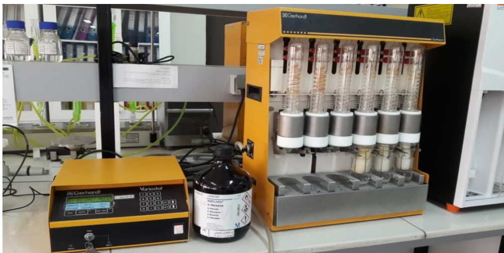
تصویر ۶-۳۴- استخراج چربی در دستگاه سوکسله
