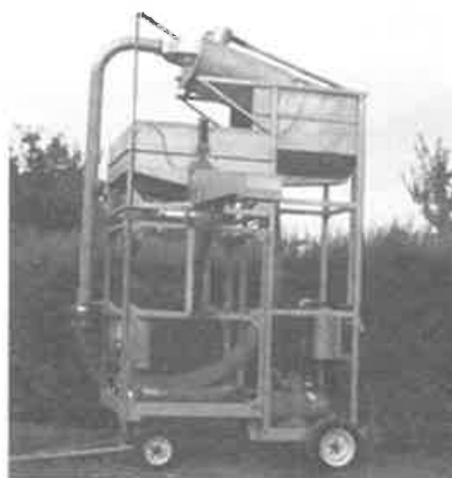
شکل ۵-۴: وسیله ای برای انتقال ماهی زنده به همراه آب از داخل استخر به مخزن حمل ماهی (اقتباس از کاتالوگ Aquatech).
