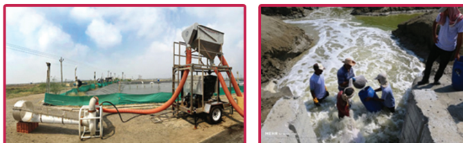
شکل ۵- برداشت میگو به روش دستی (سمت راست) و پمپ برداشت (سمت چپ)
