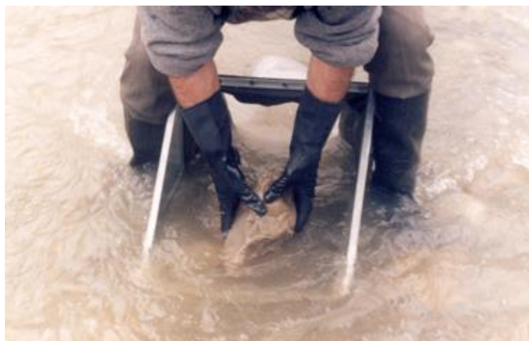
دستگاه سوربر (surber) برای نمونه برداری از آبهای جاری
