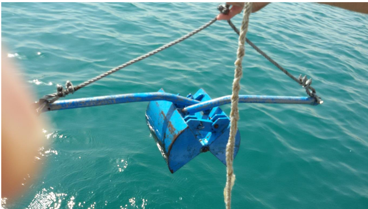
دستگاه گراب (Grab) برای نمونه برداری از آبهای ساکن
